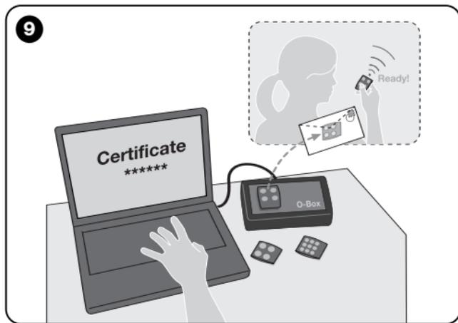
Inizialmente, la procedura prevede che l'installatore inserisca con l'O-Box, nella memoria del trasmettitore, le funzioni desiderate e il "certificato" del ricevitore in cui il trasmettitore dovrà essere memorizzato. Poi, successivamente farà recapitare al cliente il trasmettitore già pronto per all'uso.
