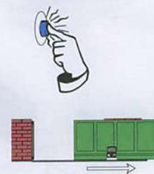
**Pulsante per «Comandi»** contatto N.O., per apertura e chiusura del cancello (vedi dip n°2) o **chiusura nel funzionamento ad azione mantenuta**, chiusura del cancello mantenendo premuto costantemente il pulsante (dip n°6 in ON).
